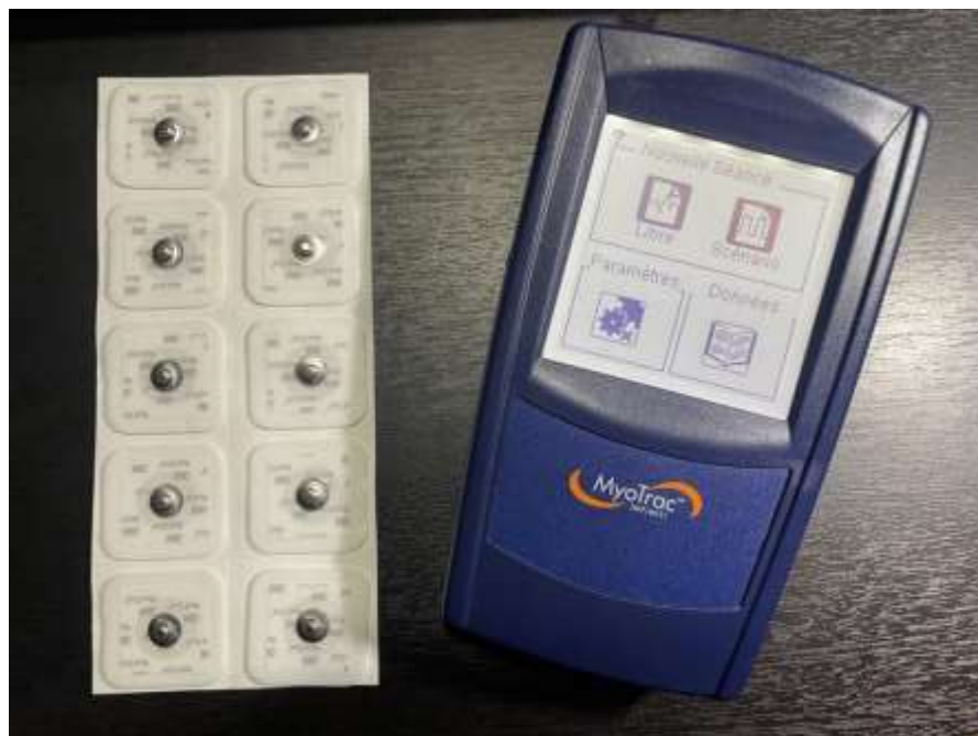
Foto 11. Equipo de electromiografía de superficie Myotrac Infiniti y electrodos que se utilizaron en valoración de la IMA
