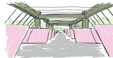
Sistema tensado por hilos que soportan los volados de todas las plantas. Cada volado se sujeta por el hilo metálico que sube hasta la cubierta y transmite la carga al la cimentación por medio de los pilares
