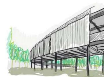
El edificio se convierte en un artefacto ajeno al lugar, que se materializa mediante un sistema de construcción en seco con piezas ensambladas y se integra en el paisaje por contraste con el mismo.
