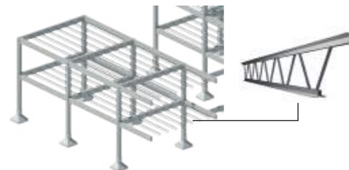
8. Sistema constructivo VIGA TEC El uso de este sistema ayuda a generar grandes luces y aligerar cargas estructurales.
