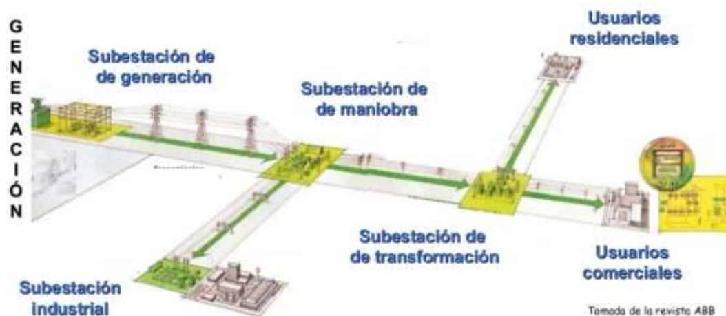
Figura 3: Tipos de subestaciones eléctricas
