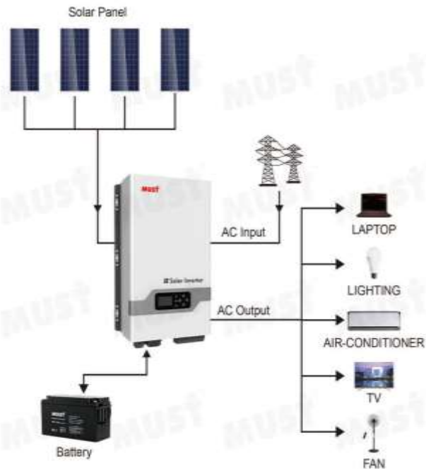
Figura 3.19. integración de elementos a inversor autónomo/híbrido Fuente: Mustsolar, 2017
