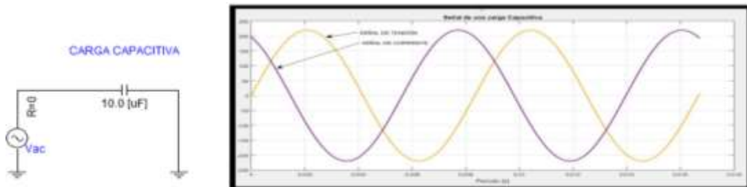
Figura 3 Representación senoidal de una carga capacitiva respecto al tiempo.
