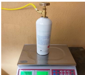
Figura 3.10: Balanza y recipiente con R290 para suministrar el peso calculado.
