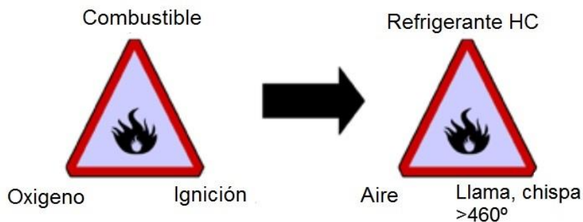
Figura 3.5: triángulo de la combustión.
