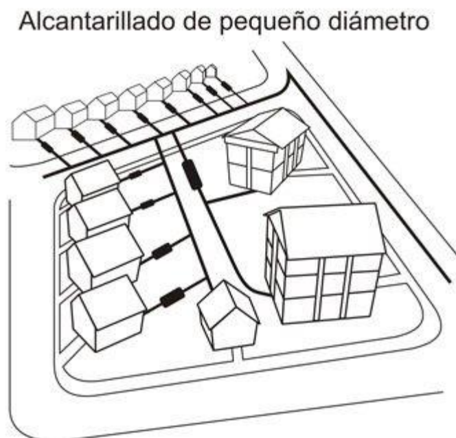
Figura 9. Esquema de Sistema de Alcantarillado Condominal
