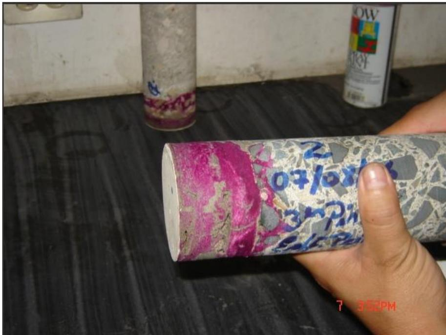
Ilustración 33 Determinación de la profundidad de carbonatación en núcleo de tercer piso. Fuente: Laboratorio de estructuras y suelos 2006.
