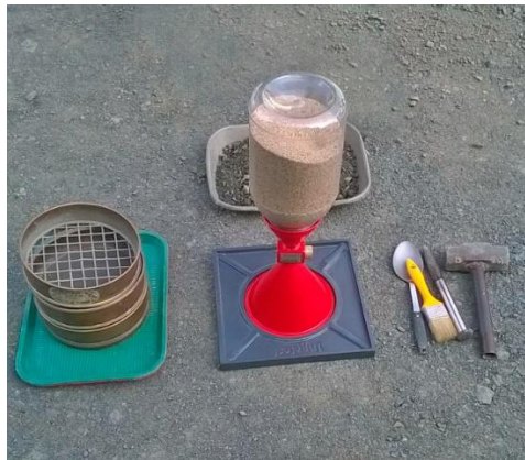
Ilustración 6.- Prueba de Cono y Arena
