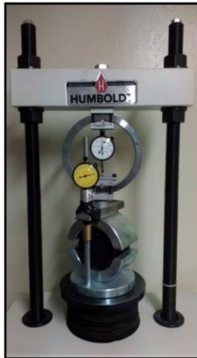
Figura 8. Ensayo estabilidad Marshall
