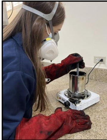
Figura 27. Calentando el cemento asfáltico.
