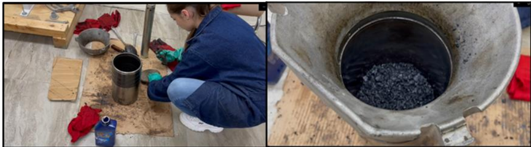
Figura 30. Colocación de la mezcla en el molde.
