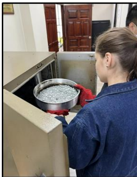
Figura 26. Colocación de los agregados en el horno de convección.
