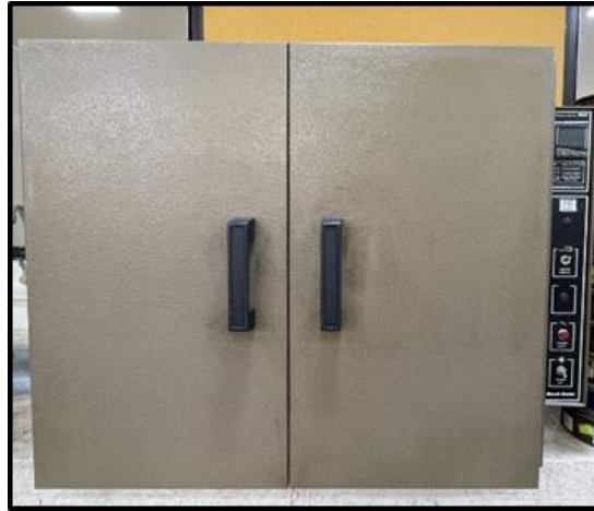
Figura 20. Horno de convección empleado para envejecimiento a largo plazo.
