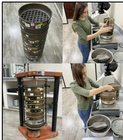
Figura 17. Pruebas de granulometría a los agregados.
