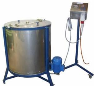
Si bien la miel adherida a los opérculos puede separarse por decantación, es un método que lleva mucho tiempo. Por ello se construyen centrífugas que aceleran el proceso, siendo parecidas al extractor.
