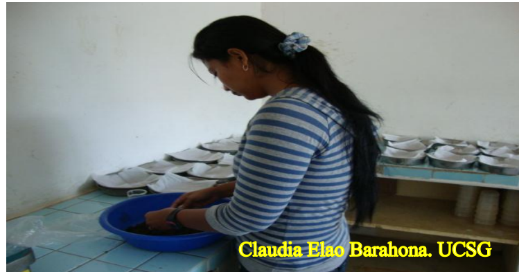
Figura 19: Homogenización de suelo para la extracción de nemátodos
