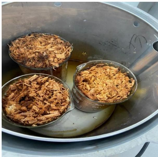
**Anexo 9.** Muestras con hidrólisis ácida en botellas de plástico con levadura al 2 % y 4 % fermentado por 5 días
