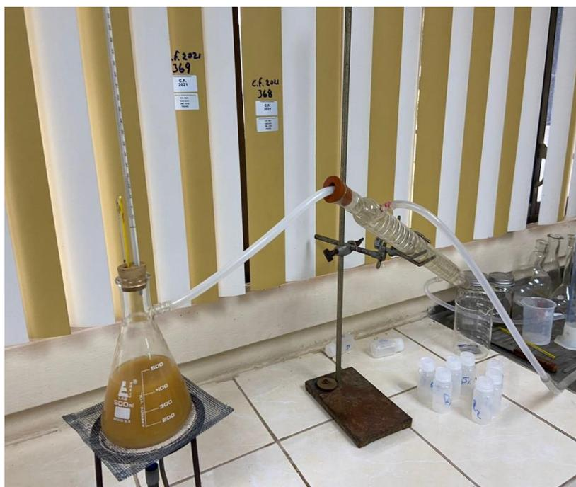
**Anexo 15.** Volumen de alcohol adquirido del proceso de destilación
