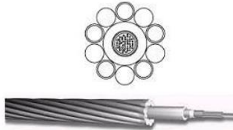
Figura 2. 15 Cable de Guarda con Fibras Ópticas OPGW
