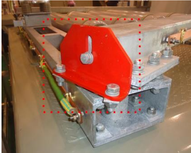
Figura 3. 7 Bloqueo de fijación en la base del pararrayos (pormenor)
