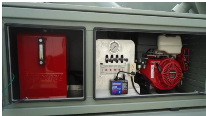
Figura 3. 3 Mando de los gatos hidráulicos
