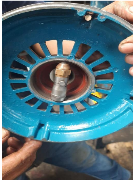
Figura 3. 3: Medición de cajera con micrómetro
