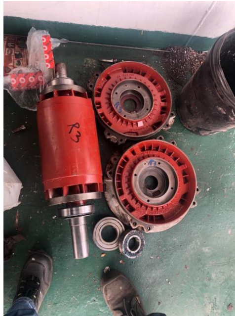
Figura 3. 2: Motor desmontaje con sus partes, roto, Cajeras y rodamientos
