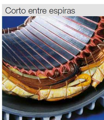
Figura 2. 3: Corto entre espiras de un motor eléctrico trifásico
