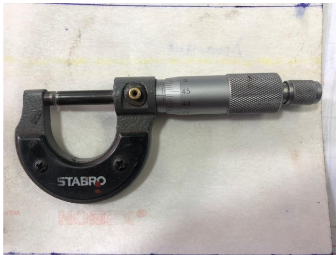
Figura 4. 3: Micrómetro para determinar calibre del alambre
