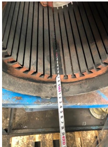
Figura 4. 4: Medida de la longitud del núcleo.
