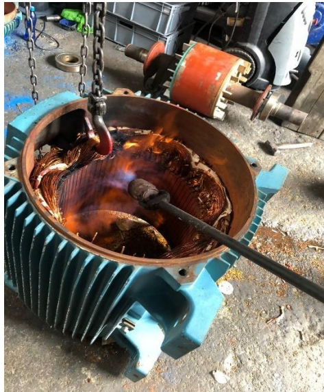
Figura 4. 2: Extracción de bobinas.
