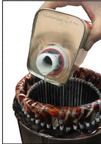
Figura 2. 12: Barnizado de un estator.
