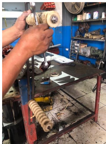
Figura 4. 8: Molde para realizar bobinas
