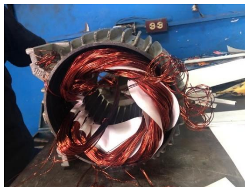
Figura 4. 10: Bobinas colocadas en el estator
