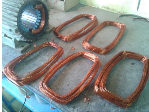
Figura 2. 6: Bobinas lista para ingresar al estator.
