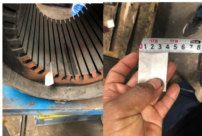
Figura 4. 5: Medida del ancho del aislante.
