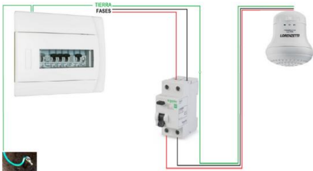
Figura 2. 3 Conexión de duchas eléctrica a 220V
