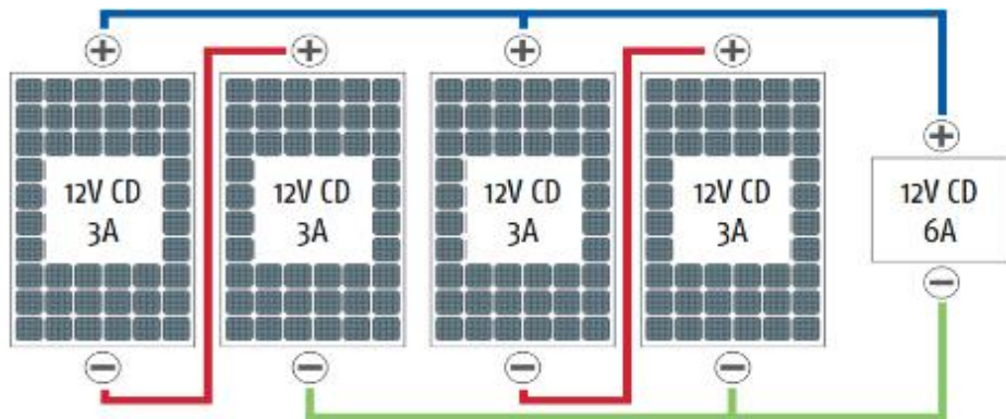
Figura 2. 19 Módulos conectados en serie y en paralelo
