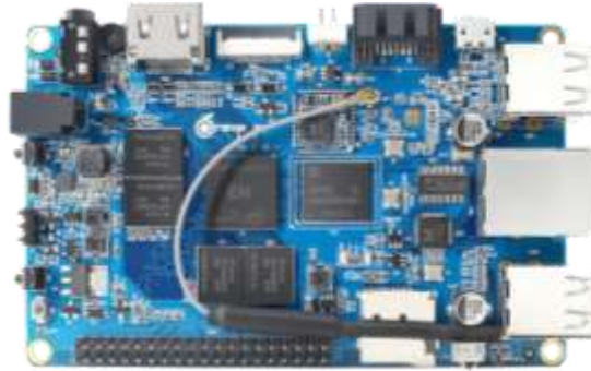
Figura 2.11: Placa Orange Pi plus 2. Fuente: (Menezes, 2018)
