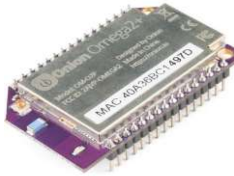
Figura 2.8: Placa Onion Omega 2+ Fuente: (Vázquez Navarro, 2018)
