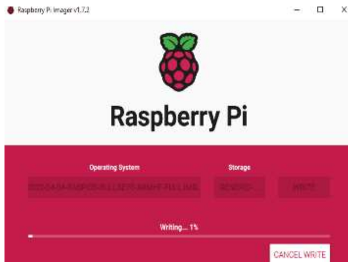
Figura 3.12: Instalación de Raspbian OS a la microSD. Fuente: El autor.
