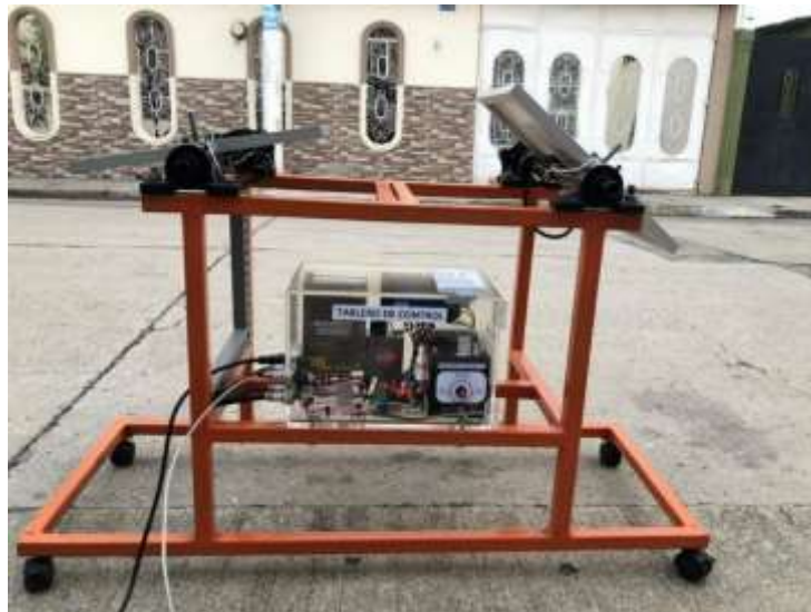
Figura 3. 7: Estructura de la base móvil del prototipo de energía solar fotovoltaica. Elaborado por: Autor.
