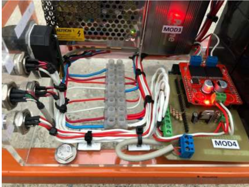
Figura 3. 5: Sistema controlador del módulo de energía solar fotovoltaica. Elaborado por: Autor.
