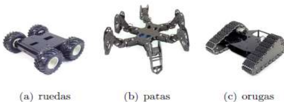
Figura 2.6 Tipos de locomoción en un robot móvil Fuente: (Cuenca, 2019)
