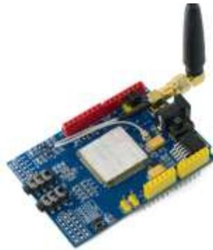
**Figura 19.-** Módulo GSM – SIM900
