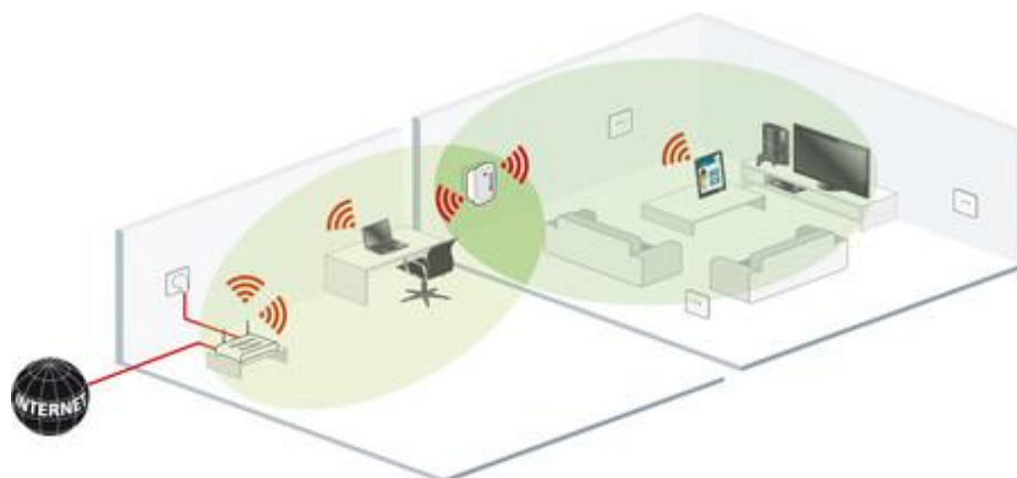
Figura 2. 10 Diagrama de funcionamiento de un repetidor.
