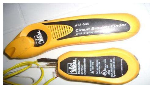
Figura 11. Seguidor de líneas eléctricas
