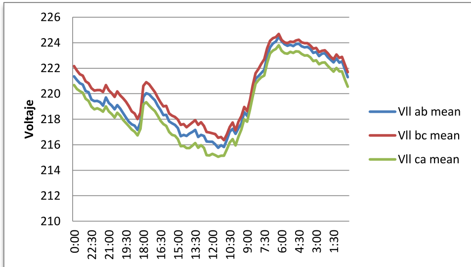
Figura 55-Medición de Voltaje, 09/11/2013
