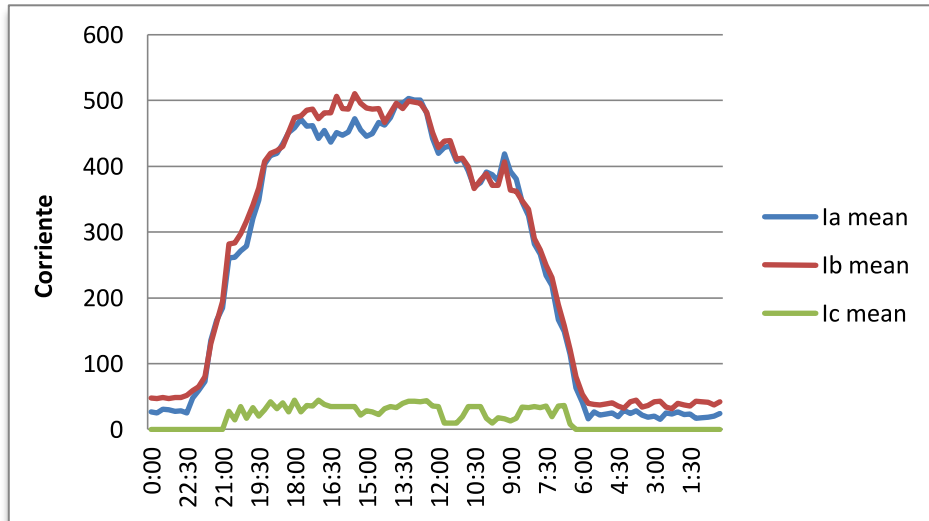
Figura 32-Medición de Corriente, 11/11/2013
