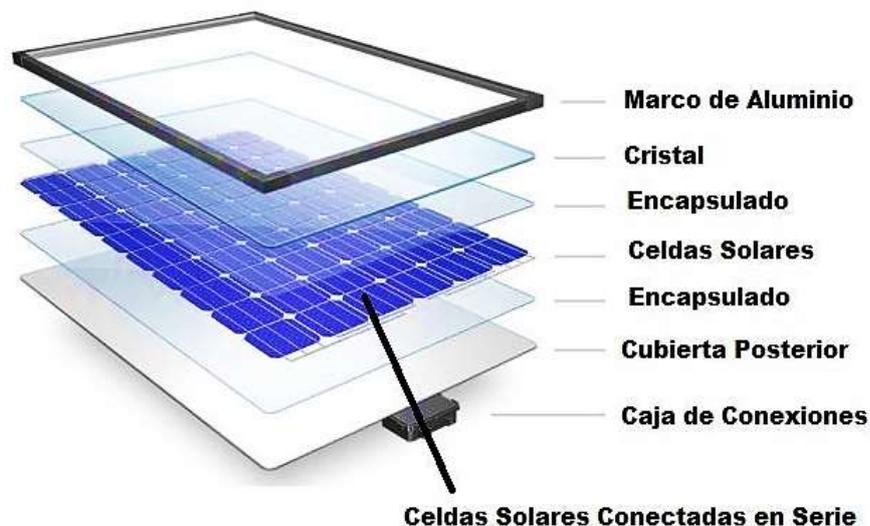
Figura 2.18: Elementos de un módulo solar
