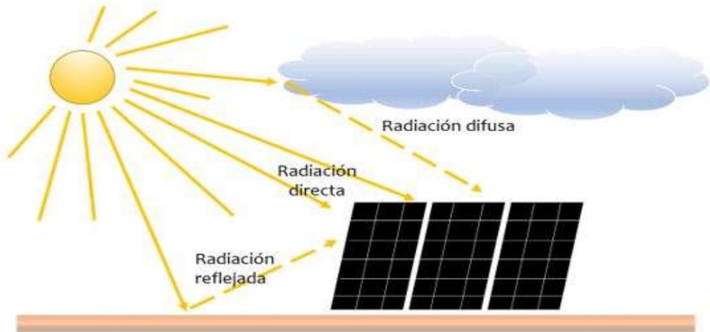
Figura 2.1: Elementos de la radiación solar
