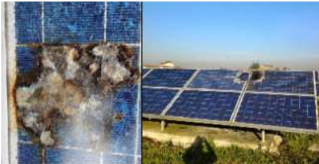
Figura 2.19: Sobrecalentamiento de un módulo solar
