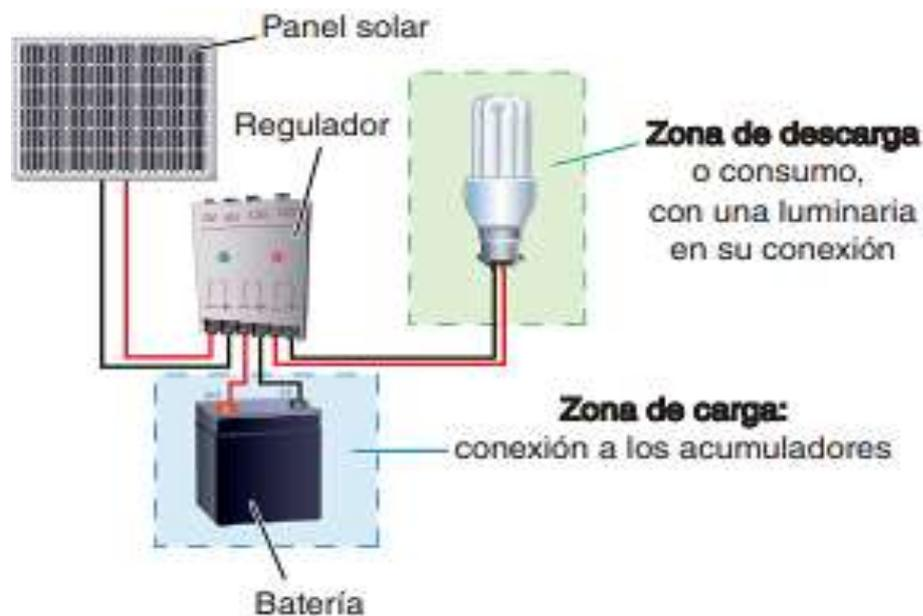
Figura 2.22: Conexión de un regulador de carga y descarga en un sistema fotovoltaico
