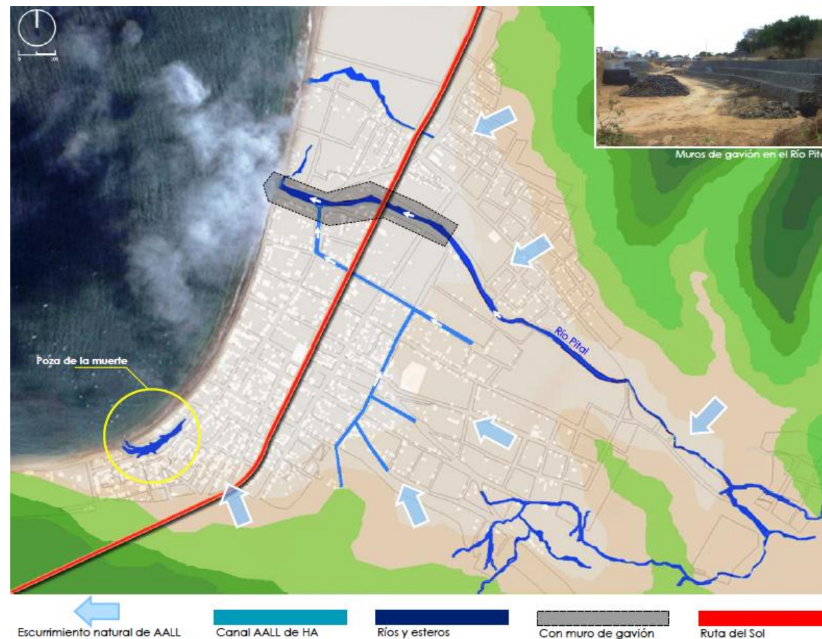
Figura 72. Plano de ubicación y formas de drenaje de las Aguas Lluvias en la Cabecera Cantonal de Puerto López.
