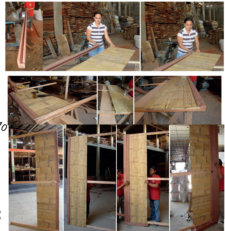
Figura 25 : Prototipos de paneles de Plas-bam. Autor: Lesly Gonzalez (2010). Diseño de paredes con ecomateriales para edificaciones de la costa ecuatoriana
