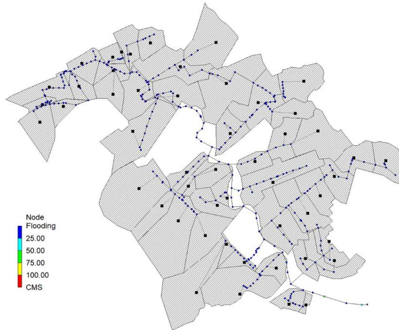
*Ilustración 24. Vista en planta del sistema post simulación con TR= 2 años. [Saltos, 2022]*
