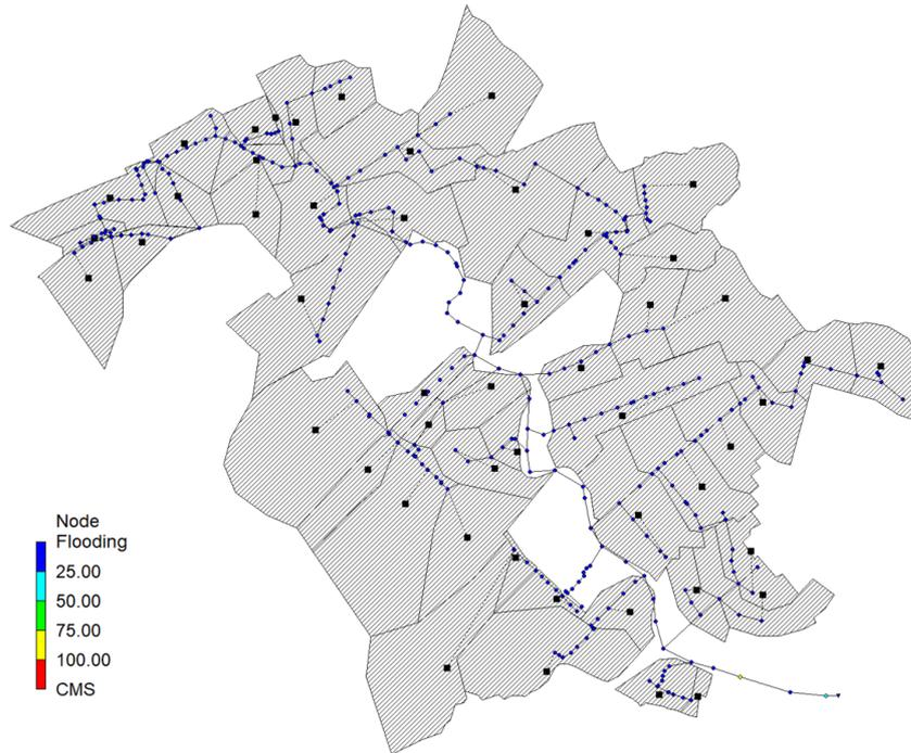
**Ilustración 94. Vista en planta del sistema post simulación con  $T_r=25$  años. [Saltos, 2022]**
