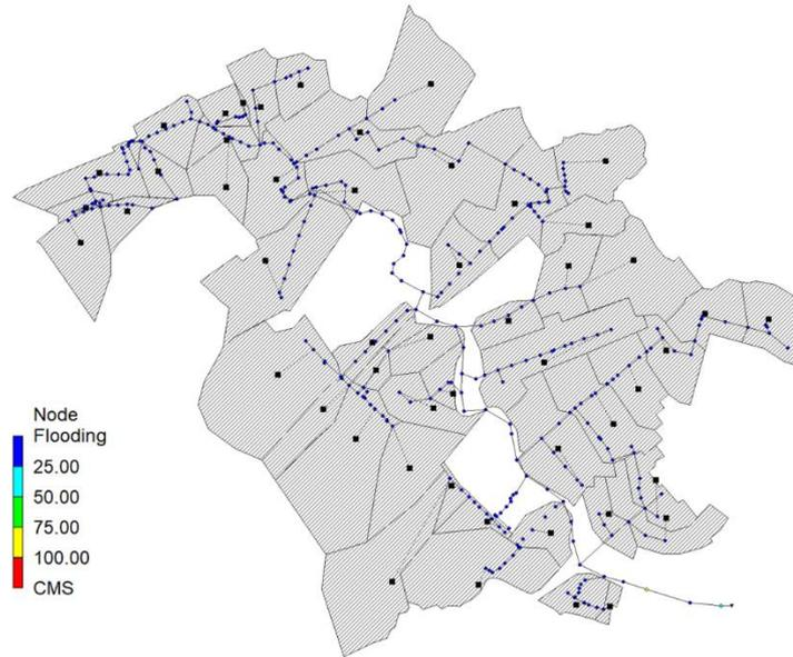
*Ilustración 64. Vista en planta del sistema post simulación con  $T_r=2$  años. [Saltos, 2022]*
