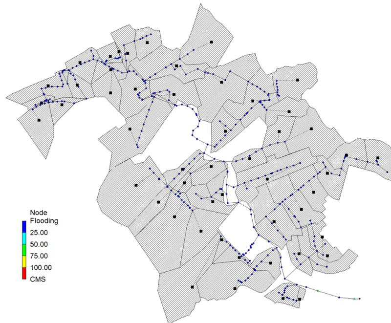
**Ilustración 54. Vista en planta del sistema post simulación con  $T_r=25$  años. [Saltos, 2022]**
