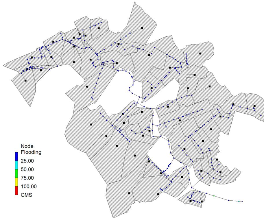
**Ilustración 34. Vista en planta del sistema post simulación con  $T_r=5$  años. [Saltos, 2022]**
