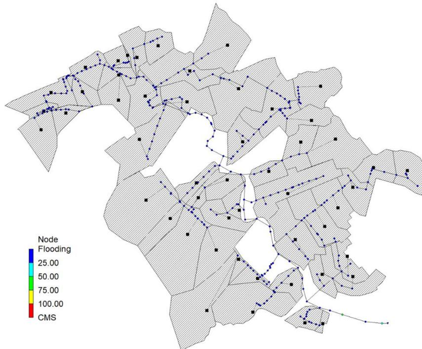
**Ilustración 44. Vista en planta del sistema post simulación con  $T_r=10$  años. [Saltos, 2022]**
