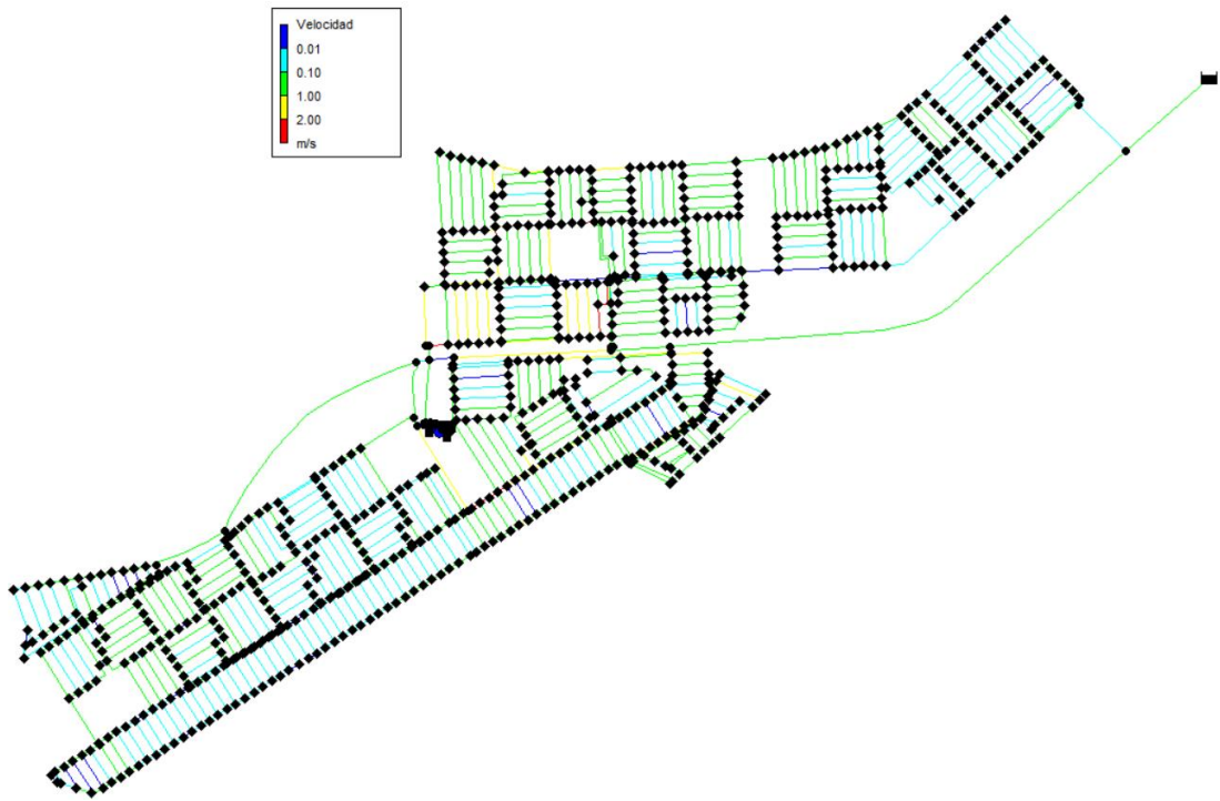
Ilustración 21 Velocidad en tuberías de RDAP El Recreo repotenciado
