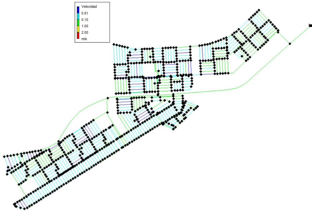
Ilustración 18 Velocidad en tuberías de RDAP El Recreo
