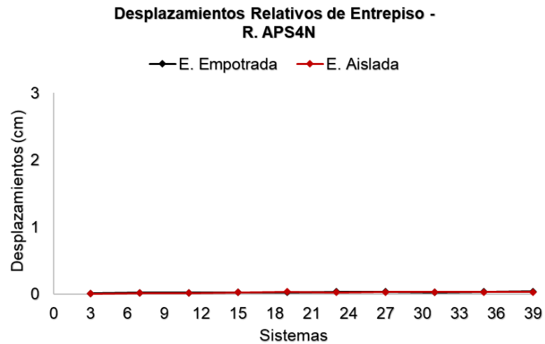
Ilustración 142 Desplazamientos Máximos Relativos de Entrepiso de los sistemas aislados y empotrados para el registro APS4N
