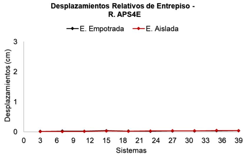
Ilustración 141 Desplazamientos Máximos Relativos de Entrepiso de los sistemas aislados y empotrados para el registro APS4E
