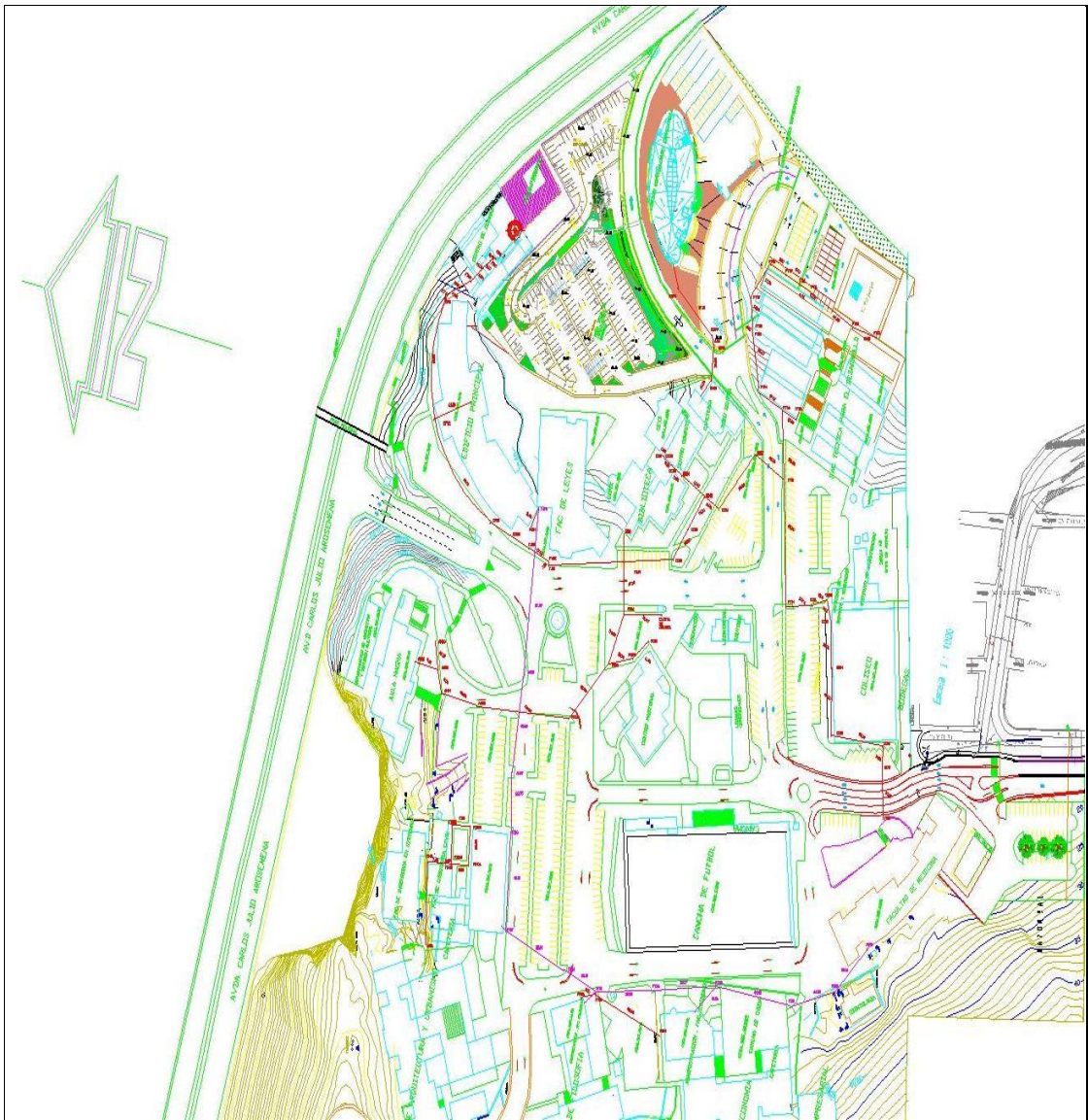
Figura 3.1: Plano de red de datos del campus UCSG.
