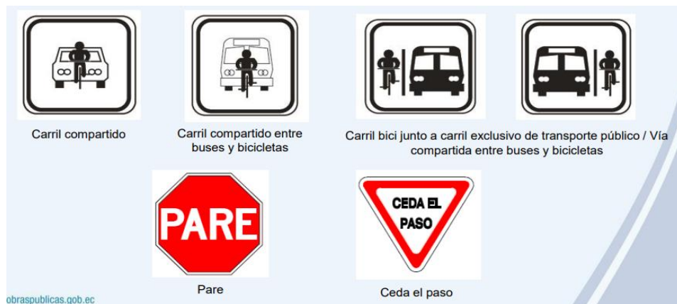
Figura 50. Señalización vertical, serie de prioridad de paso
