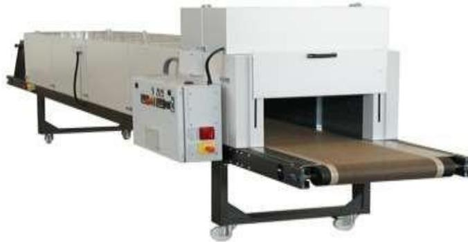
Figura2. 6: Secador Tipo Túnel
