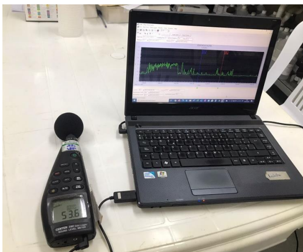
Figura 3. 19: Sonómetro conectado a PC con el software activo
