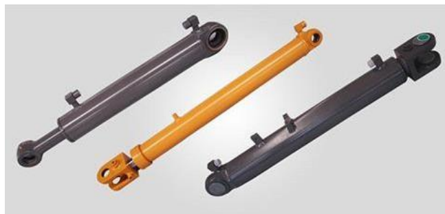
Figura 2. 4: Cilindros de excavadora VOLVO Fuente: (Marquez, 2018)
