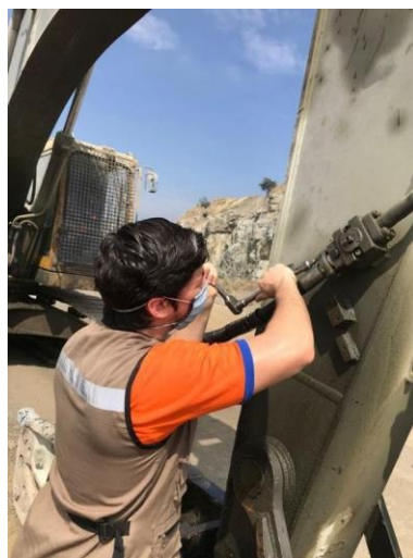
Figura 3. 16: Ajuste de pernos de manguera a válvula Fuente: El autor
