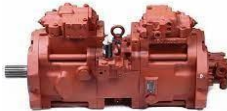
Figura 2. 3: Bomba hidráulica tipo K3V Fuente: (Kawasaki, 2018)
