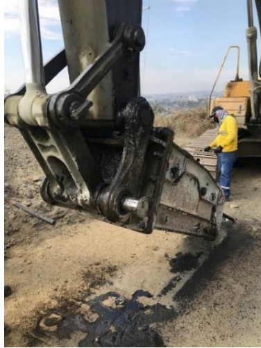
Figura 3. 12: Martillo en posición para insertar pin superior Fuente: El autor
