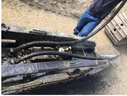
Figura 3. 14: Mangueras de entrada y salida de aceite Fuente: El autor
