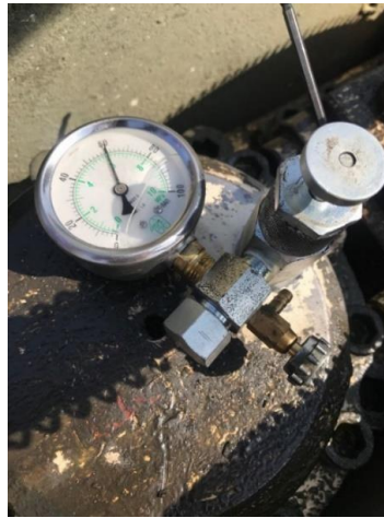
Figura 3. 7: Manómetro de válvula marcando 60mbar
