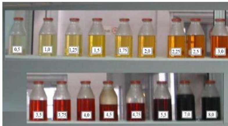
Figura 3. 9. Colores y examen visual bajo la normativa ASTM D1524.
