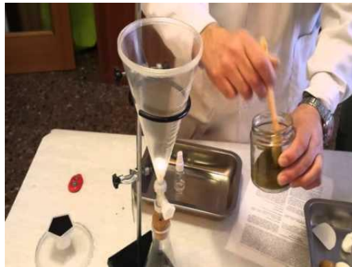
Figura 3. 13. Metodología de percolación por gravedad.
