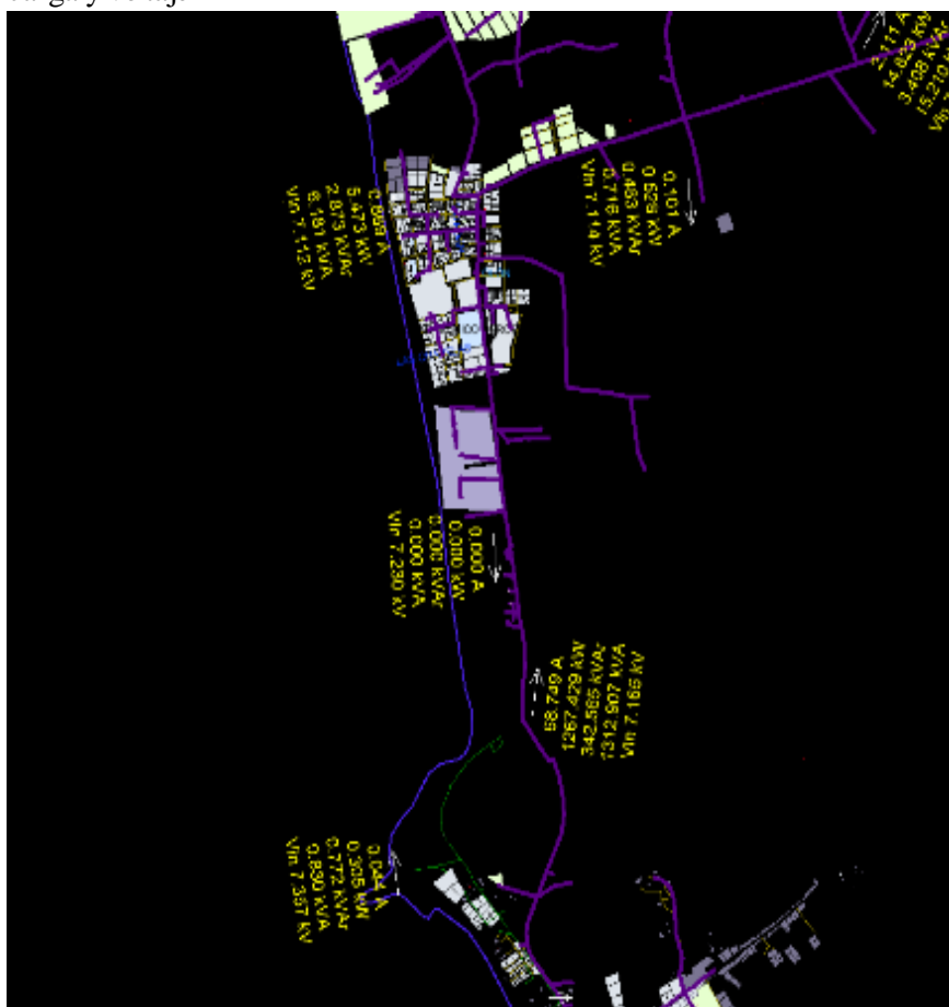
Figura 17. Segunda simulación del flujo de carga en programa SCADA; parámetros de carga y voltaje
