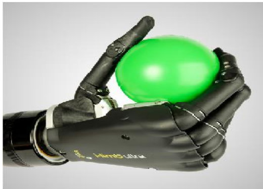
Figura 2-8 Modelo de Prótesis biónica | Limb sosteniendo una pelota de plástico Fuente: (Ferriz, 2022)
