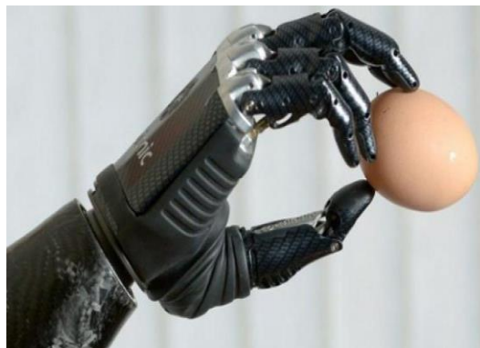
Figura 2-10 Modelo de Prótesis Bebionic sosteniendo un huevo Fuente: (Sophimania, 2012)
