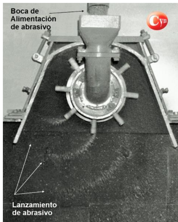
Figura 2.3 Estructura de turbina de granallado
