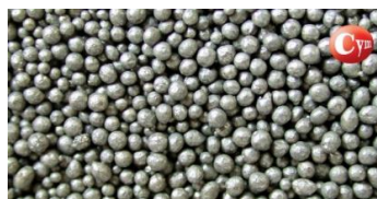
Figura 2.2 Granalla de acero al carbono tipo esférica
