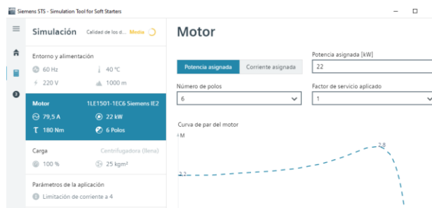
Figura 3.9 Simulación de arrancador suave con software Siemens STS
