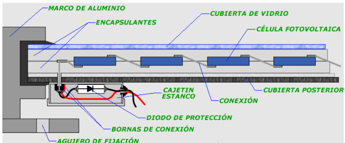
Figura 2. 4: Componentes de un módulo fotovoltaico. Fuente: (González Marín, 2020)
