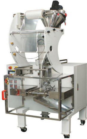
Figura 3. 3 Dosificadora volumétrica de tornillo sinfín para polvos Fuente: (Italian Packing Machine, 2021)
