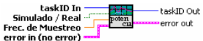
Fig. 4.14 Diagrama de flujo e Icono SubVI Potenciav.vi.
