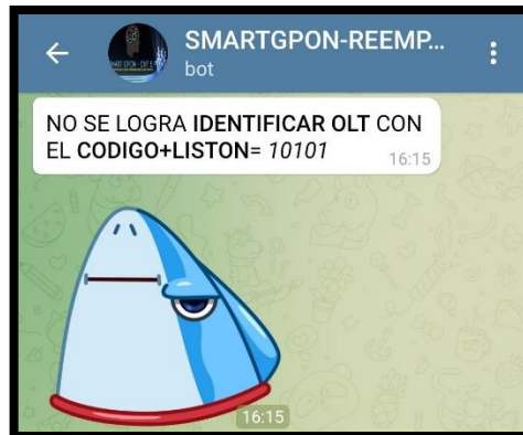
Figura 3.100: Mensaje informativo indicando el Código de Distribuidor y primer digito de Listón no identificado en BDD-COD_OLT enviado por el Sistema @SMARTGPON-REEMPLAZOS a los administradores Fuente: autor
