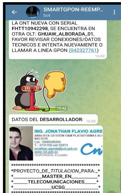
Figura 3.106: ONT nueva se localiza en una OLT diferente a la ONT Antigua validado por el Sistema @SMARTGPON-REEMPLAZOS Fuente: autor
