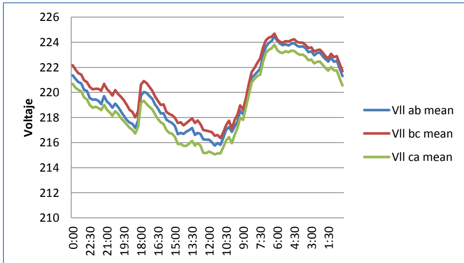
Figura 3.55. Grafica Voltaje vs tiempo del banco trifásico, del Edificio de Laboratorios, Sábado 09 /11/2013
