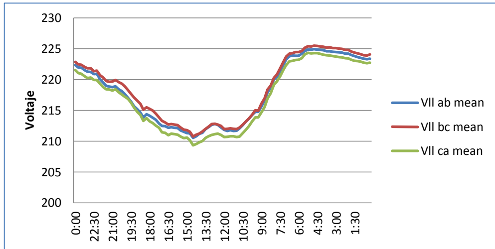
Figura 3.59. Grafica Voltaje vs tiempo del banco trifásico, del Edificio de Laboratorios, Lunes 11 /11/2013
