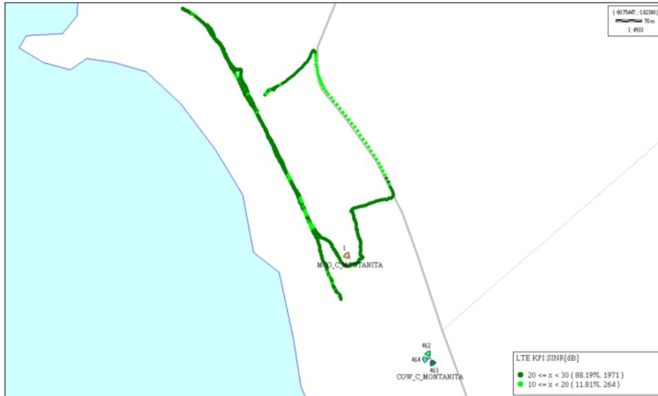
Fig. 3.3 Medición de SINR en Montañita
