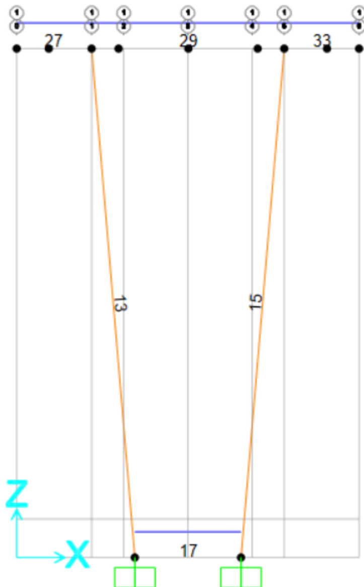
Ilustración 42. Modelado en SAP 2000 para pila #12. Fuente: Elaboración propia de autor.
