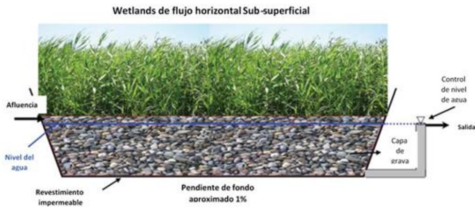
Ilustración 5.- Representación esquemática de una sección transversal típica de un humedal artificial por flujo subsuperficial.
