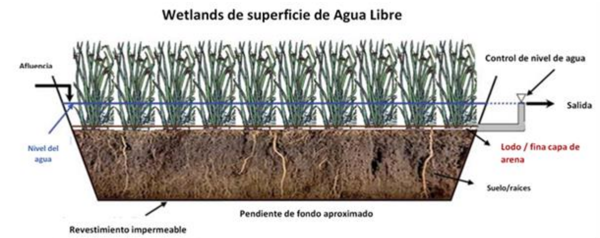
Ilustración 4.- Esquema transversal de un humedal superficial. Extraído de :(Taberham et al., 2018)
