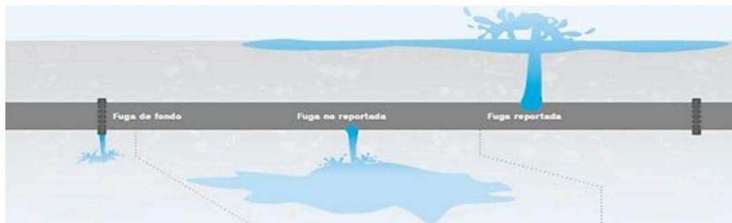
Ilustración 3. Clasificación de Perdidas Reales según su tamaño y tiempo de la fuga
