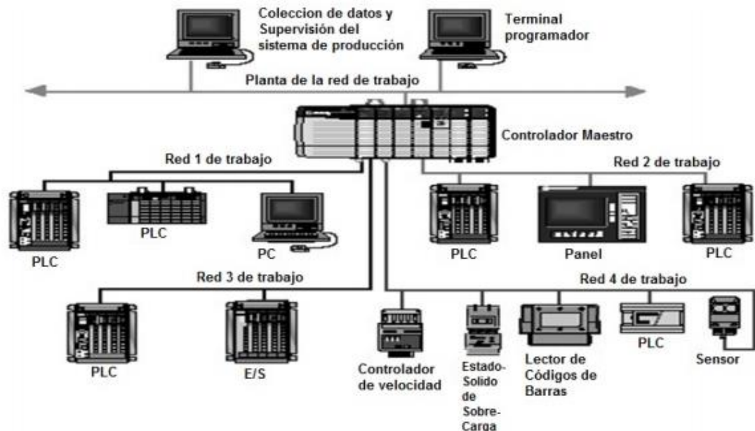
Figura 5 Configuración de un PLC Bajo Arquitectura “Maestro Esclavo”
