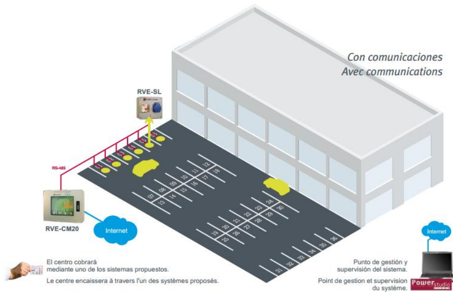
Figura 4. 2: Distribución de equipos de carga con comunicaciones. Fuente: Circuitor.
