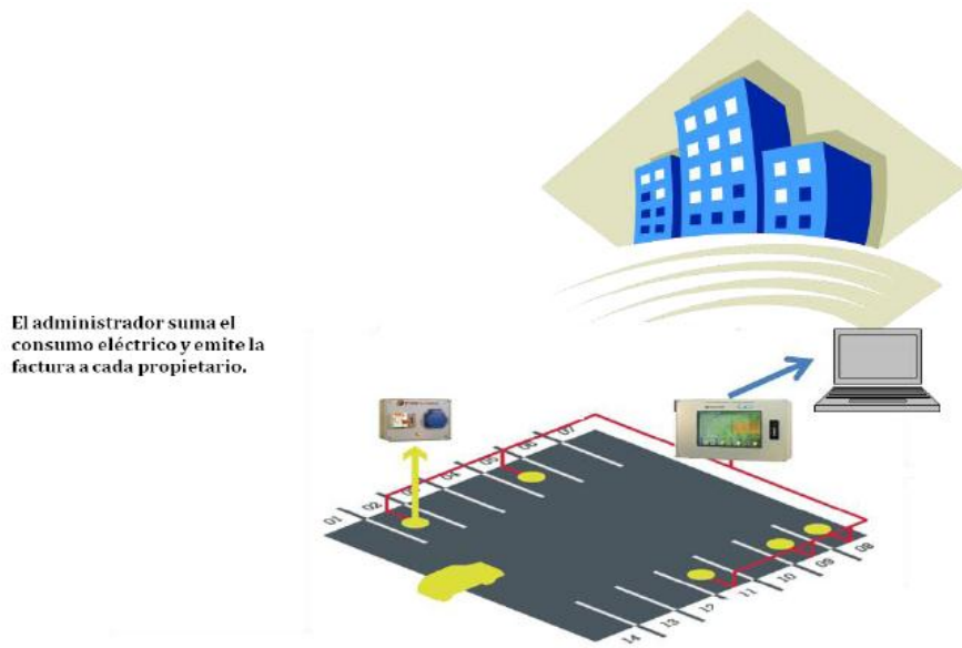
Figura 3. 3: Sistema de recarga para baterías en vehículos eléctricos. . Fuente: Ceña, A. & Santamarta, J. (2009)
