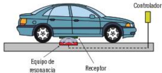
Figura 2. 14: Recarga de vehículos eléctricos a control remoto y por resonancia magnética.
