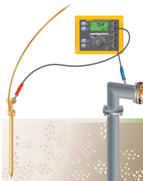
Figura 2. 20 Circuito equivalente para medida de dos puntos.
