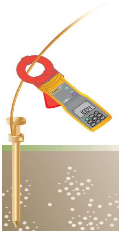
Figura 2. 19 Configuración para método sin picas utilizando el 1630-2 FC.
