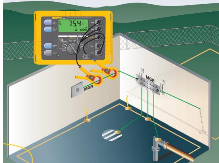
Figura 2. 22 Comprobación sin picas de una oficina central.
