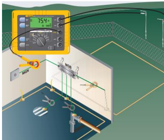
Figura 2. 24 Medición de las resistencias individuales del sistema de conexión a tierra.
