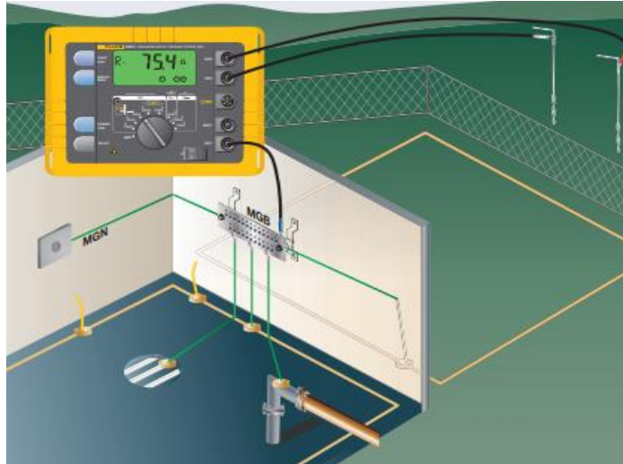
Figura 2. 23 Comprobación de caída de potencial de 3 polos en el sistema a tierra.
